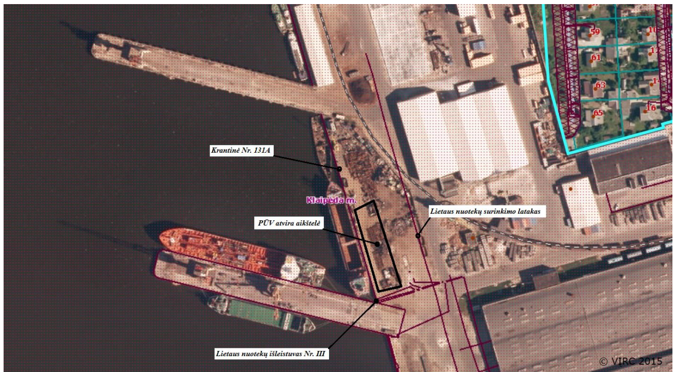
Paviršinių nuotekų surinkimo tinklų ir nuotekų išleistuvo Nr. III schema
